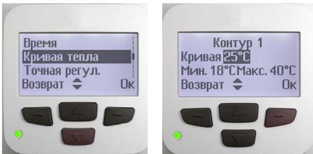
7.2.6.2 Нажимая **ВК** и **НК** выбираем нужную отопительную кривую (от 22°C до 60°C).
