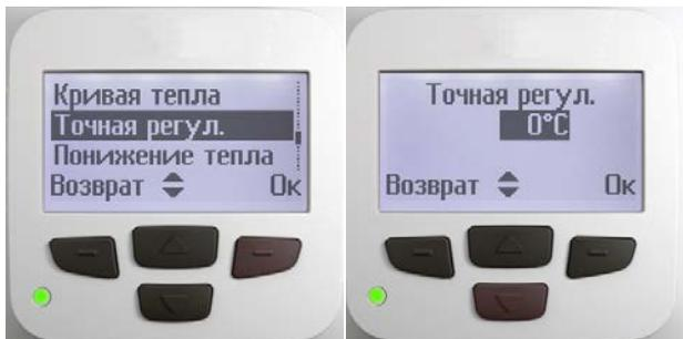
7.2.7.2 Нажимая **ВК** и **НК** выбираем сдвиг отопительной кривой (от -20°C до +20°C). (Наклон кривой при этом не меняется.)
